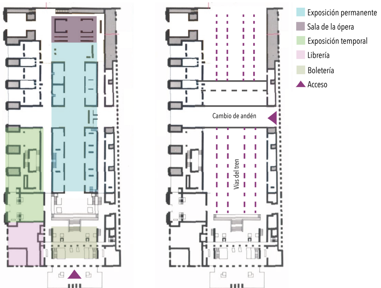
Fig 8. Musée d'Orsay. Reconversión de los espacios interiores para un nuevo uso. Planta del Museo en 1986 (izq.) y planta de la estación en 1900 (der.) Dibujos del autor, en base a planos de Mettais, V. (1999). Su visita a orsay . Versailles: Art Lys.
